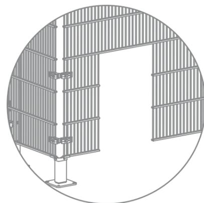
Le dimensioni e la posizione delle aperture non devono influire sulla stabilità delle griglie Elemento.
